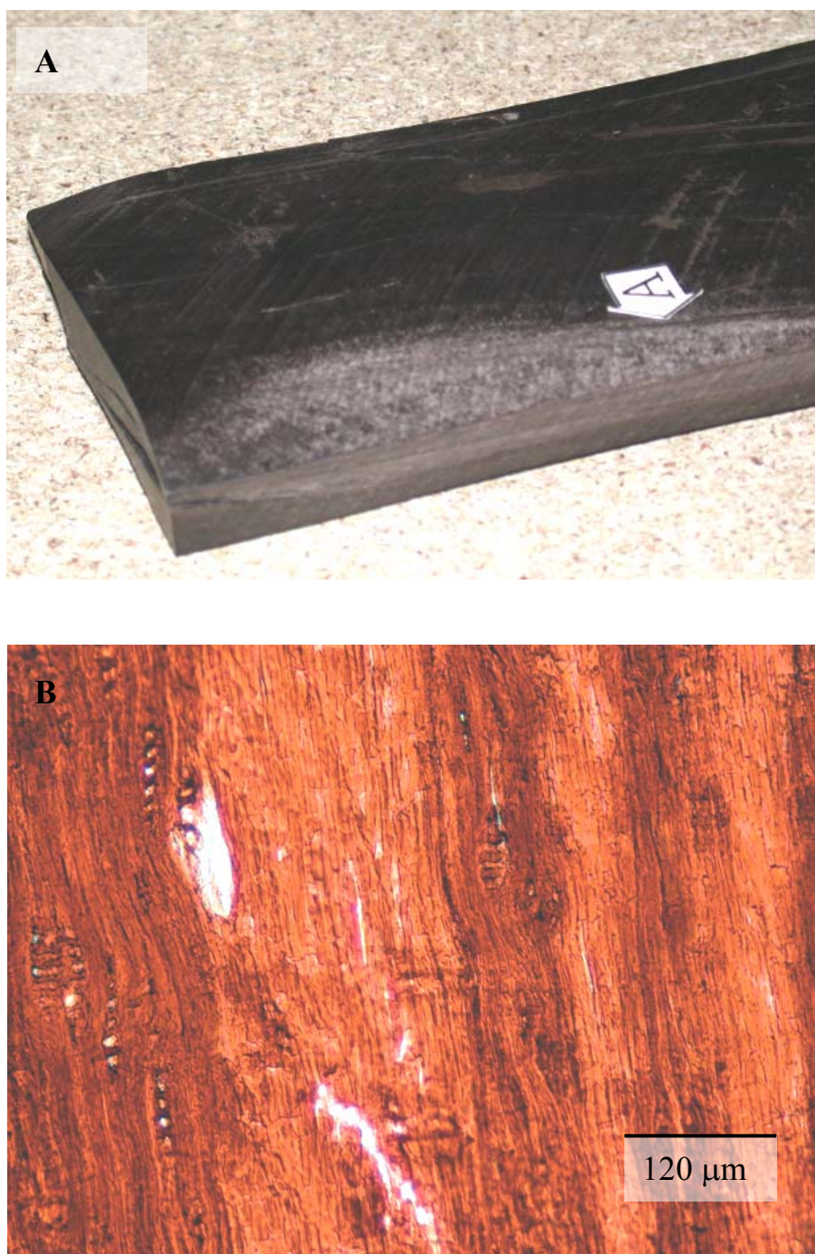
Slika 5.13 Nerazpoznavna orientacija večjega števila čelnih razpok (A) je posledica »raztrganega« in prepletenega tkiva (B) ter močnejših kemičnih sprememb.
