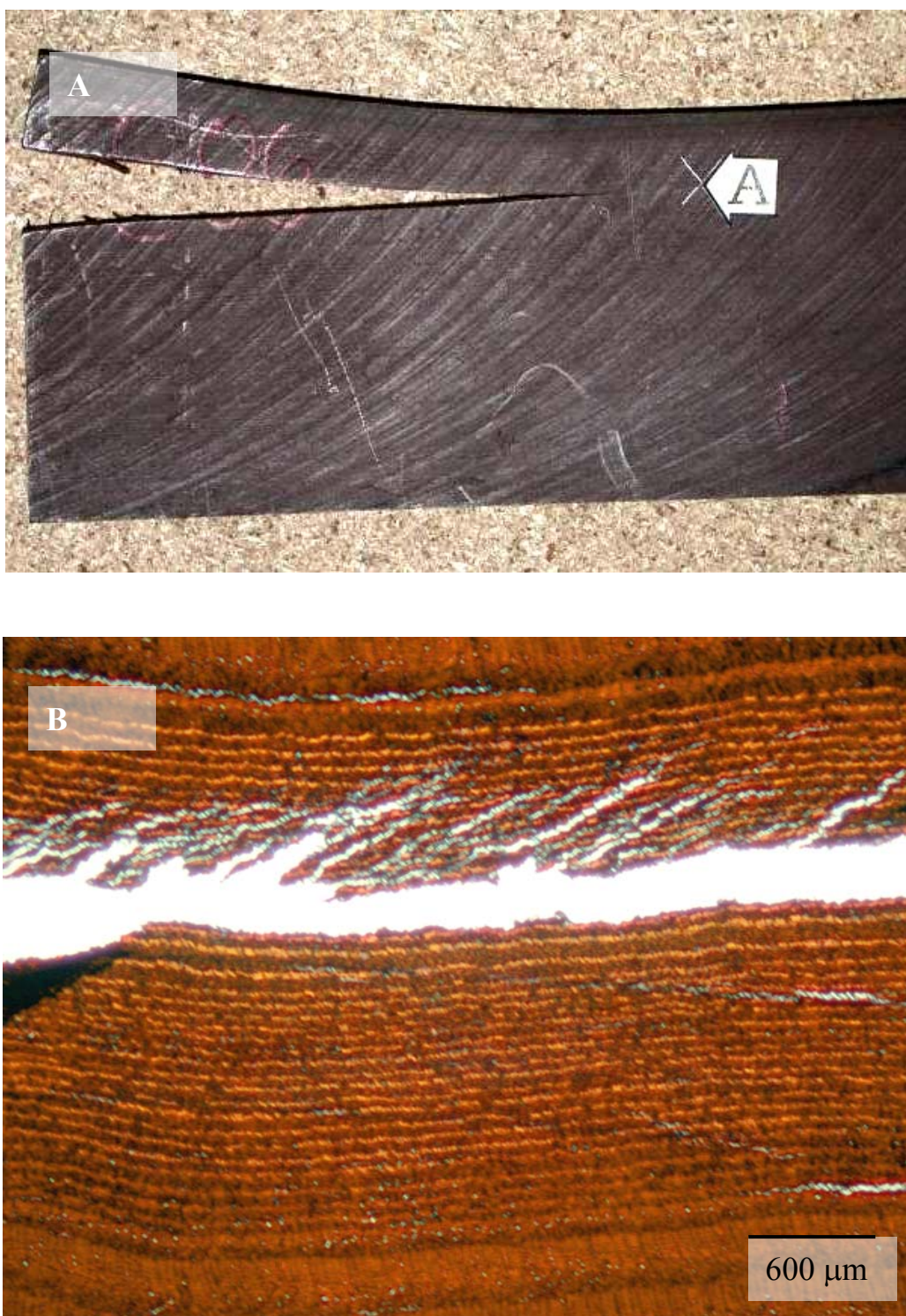
Slika 5.4 Razklanost vzorcev s čelne strani (A) je posledica različne zgradbe posameznih plasti tkiva, ki se med sušenjem različno krčijo in s tem povzročajo notranje napetost (B).
