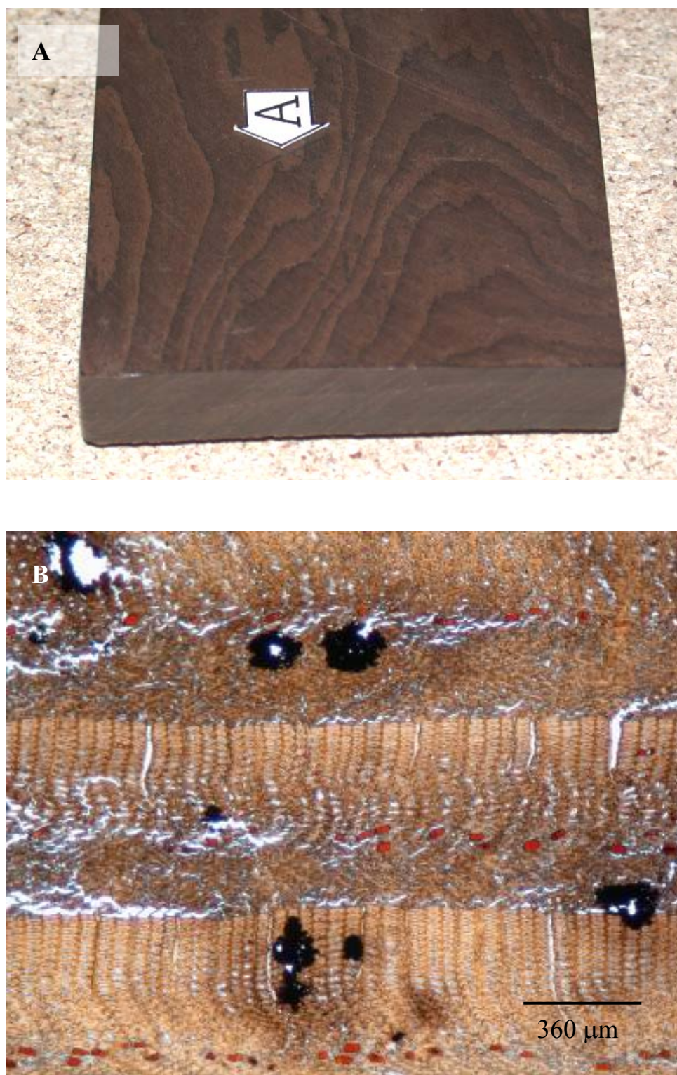
Slika 5.15 Na tangencialni površini je razpoka slabše vidna (A), razločna pa je na robovih. Kljub urejeni strukturi je tkivo porušeno v tangencialnih in radialnih smereh (B in C).
