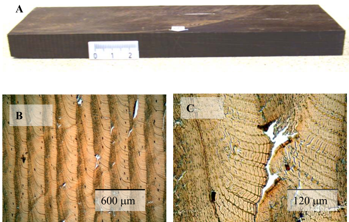
Slika 5.11 Zrušitev celičnih sten je značilna za rani les, kjer so močne strižne napetosti povzročile »zdrse« ranega čez kasni les (B in C).
