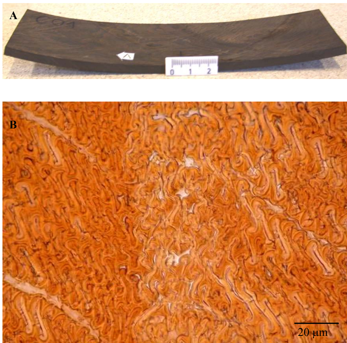
Slika 5.1 Značilna deformacija (A) tanjših elementov ksilita ( d = 6\text{mm} ) kot posledica plastne strukture vidne na mikroskopski sliki (B).
