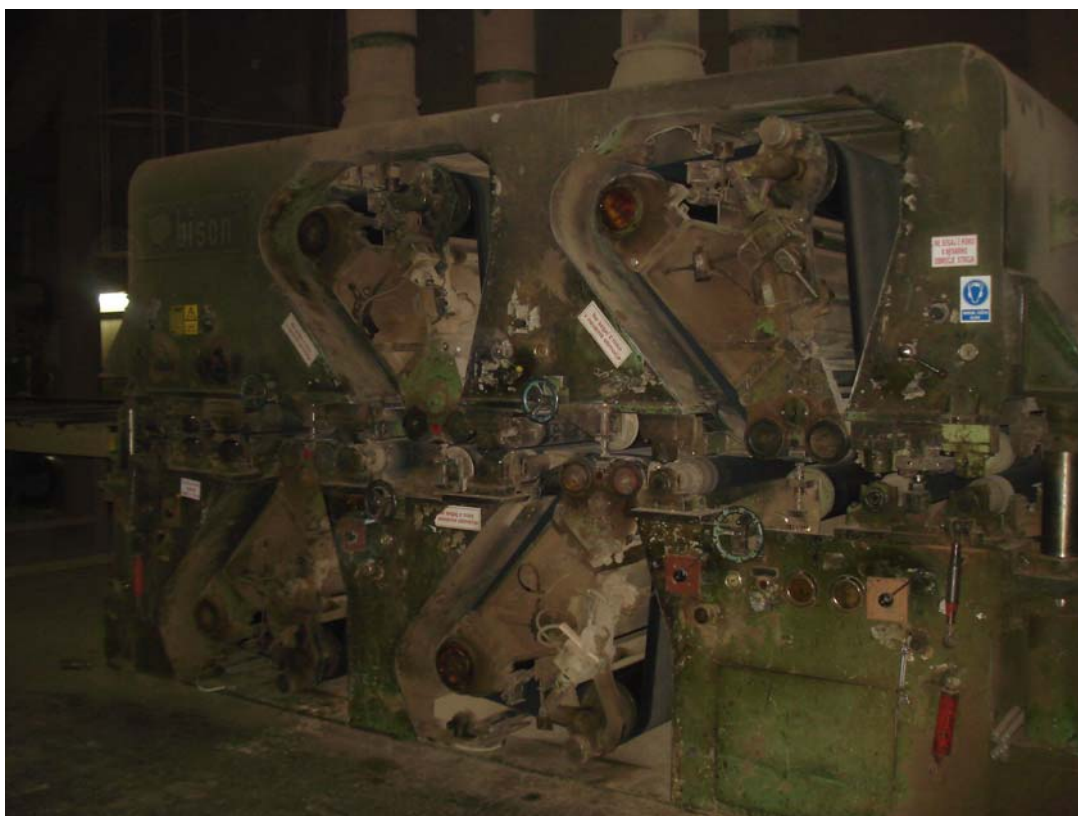
Slika 5: Sklop druge in tretje brusne postaje
