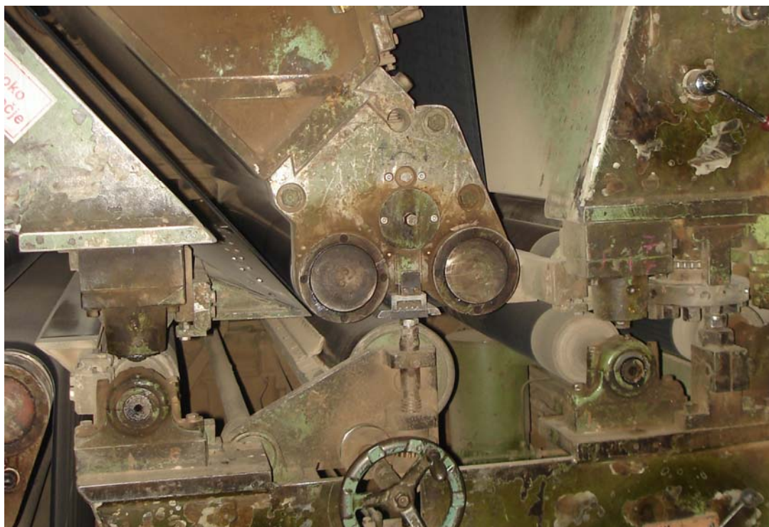
Slika 6: Drsna letev med valjema
