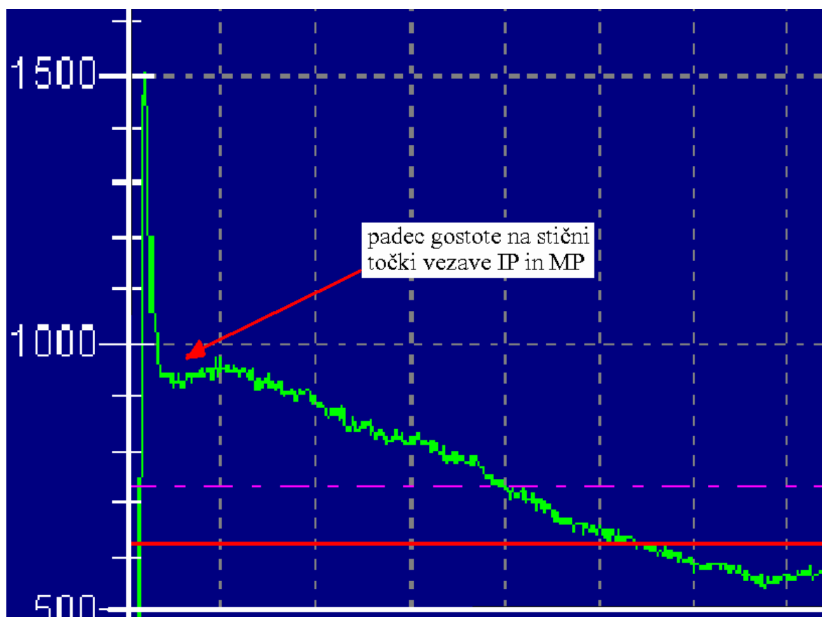
Slika 13: Padec gostote na stični meji IP in MP
