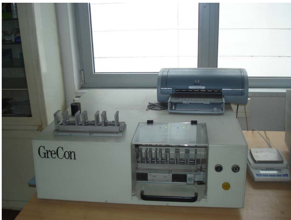
Slika 11: Merilec vertikalnih prostorninskih mas GreCon s pripadajočo pomožno opremo
