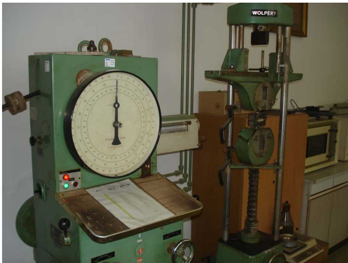
Slika 9: Trgalni stroj Wolpert
