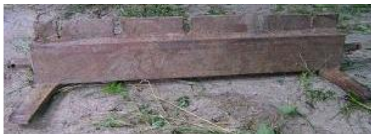
Slika 18: Prečka za vleko hlodov (foto: J. Potrpin)
