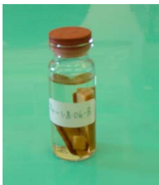
Slika 5: Obdelani količki v 15 ml penicilinki s 70 % etanolom.
