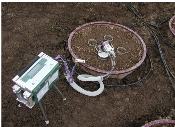
Slika 4: Meritev hitrosti toka talnega CO 2 skozi ovratnik (Foto: Dominik Vodnik)
