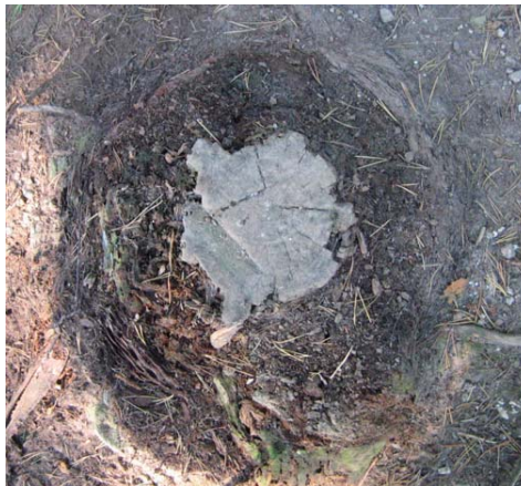
Slika 1: Popolnoma razkrojena beljava in skoraj nedotaknjena jedrovina borovega štora (foto: Humar)
