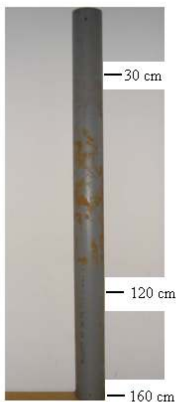
Slika 5: Cev vstavljena v barjanska tla do globine 160 cm na poskusnem polju v Tomišlju (Stres, 2008)
