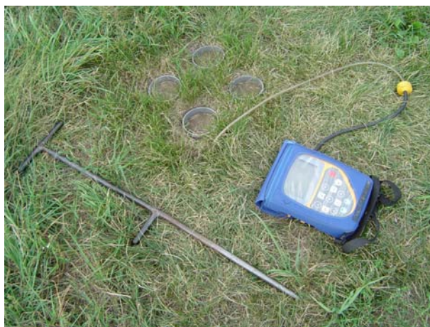
Slika 7: Prenosni analizator plinov GA 2000 s talno sondo (Foto: D. Vodnik).
