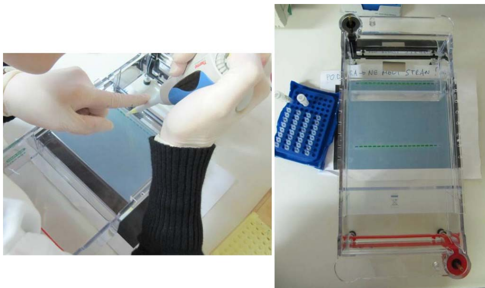
Slika 11: Nanos vzorcev v žepke na agaroznem gelu in potek elektroforeze.
