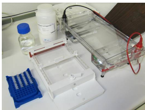
Slika 10: Banjica za potek elektroforeze in model z glavnikom za izdelavo agaroznega gela.
