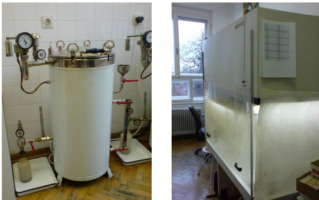
Slika 11: Avtoklav (levo) in Laminarij (desno)
