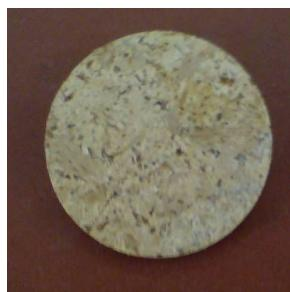
Slika 45: Substrat okužen z ogljeno kroglico (*Hypoxylon fragiforme*) stisnjen v tableto pripravljen za meritev XRF
