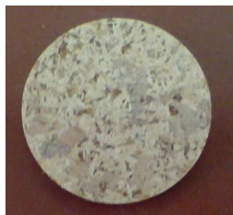
Slika 48: Substrat okužen z belo hišno gobo (*Antrodia vaillantii*) stisnjen v tableto pripravljen za meritev XRF
