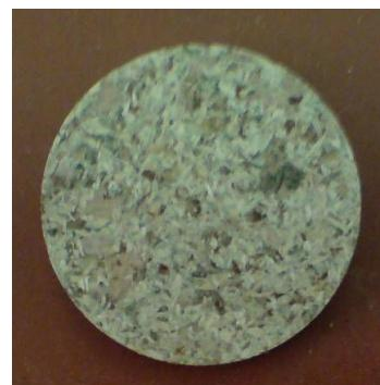
Slika 51: Plesniv substrat stisnjen v tableto pripravljen za meritev XRF
