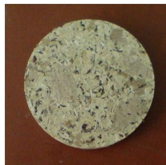
Slika 42: Kontrolni, neokužen substrat stisnjen v tableto pripravljen za meritev XRF
