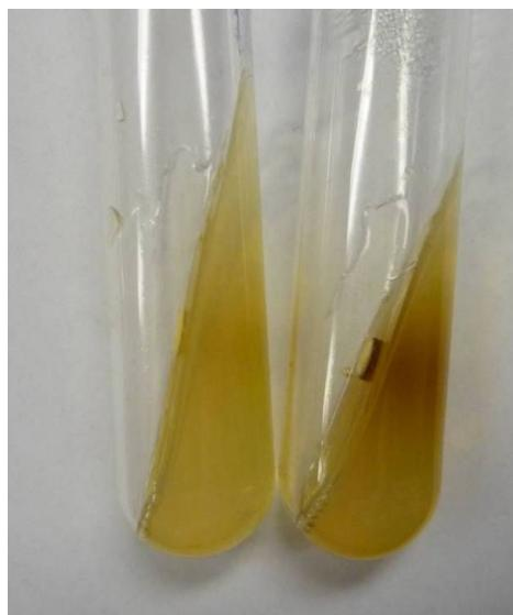
Slika 32: Obarvanje hranilnega gojišča pri navadni tramovki (*Gloeophyllum trabeum*) brez kositra (leva epruveta) in s 250 ppm kositra (desna epruveta)
