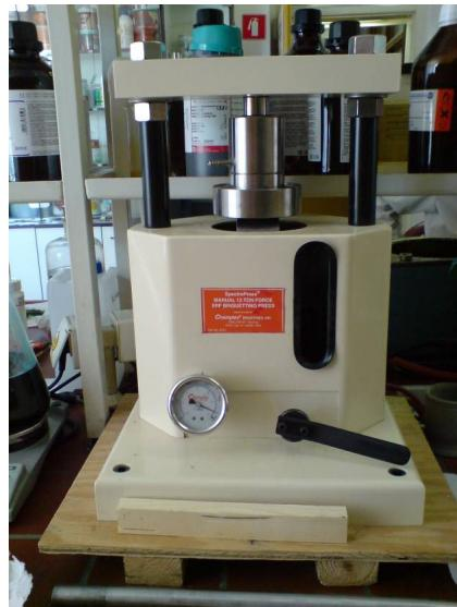
Slika 20: Stiskalnica za izdelavo tablet za analizo XRF
