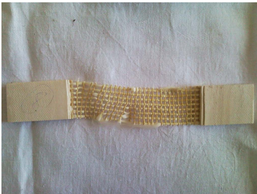
Slika 10: Preskušanelec iz sintetične mreže po natezni obremenitvi
