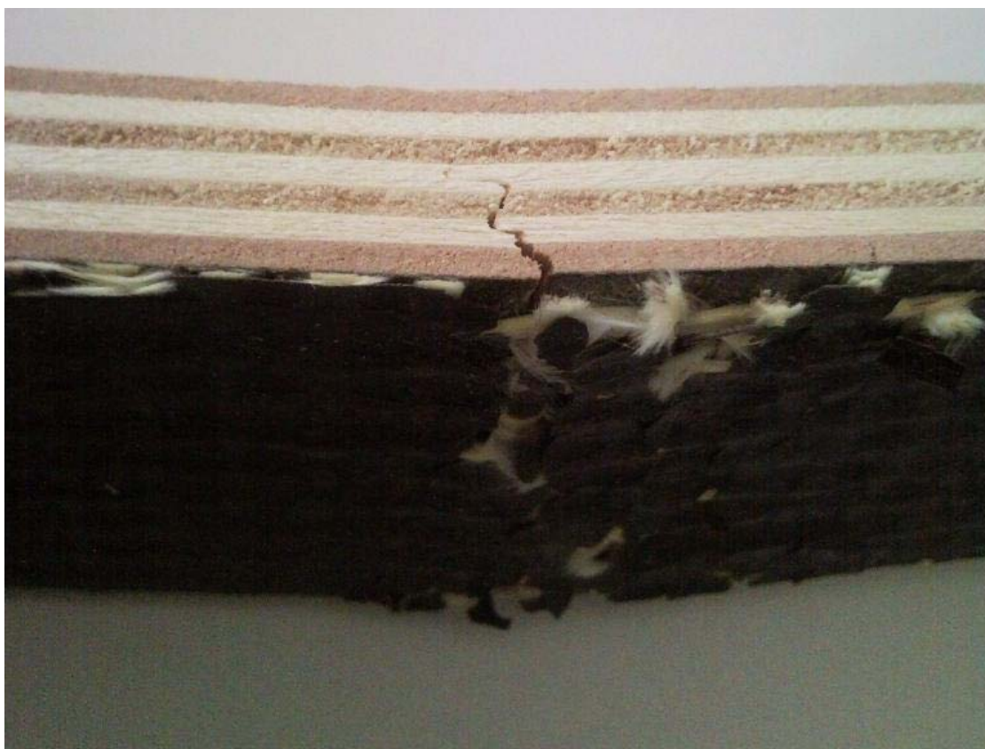
Slika 18: Detajl preloma preskušanca sestave B2 pri obremenitvi na upogib
