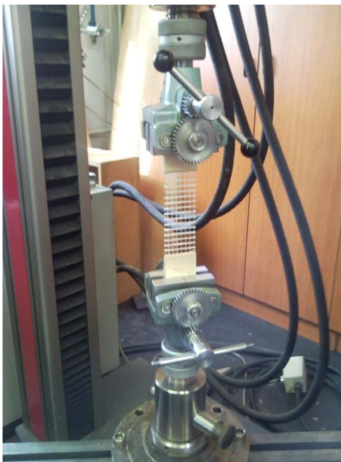
Slika 9: Vpet preskušanelec iz sintetične mreže pred natezno obremenitvijo
