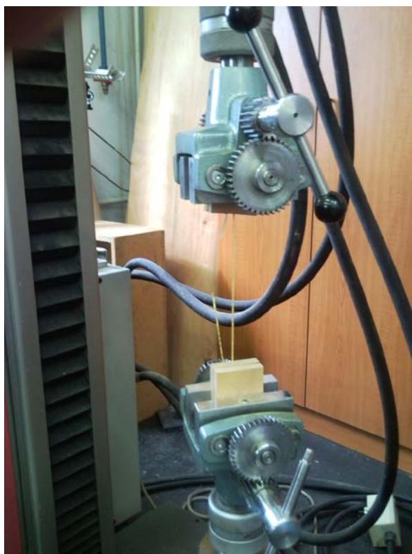
Slika 11: Prikaz vpetja posamezne preje v čeljusti stroja Zwick Z100
