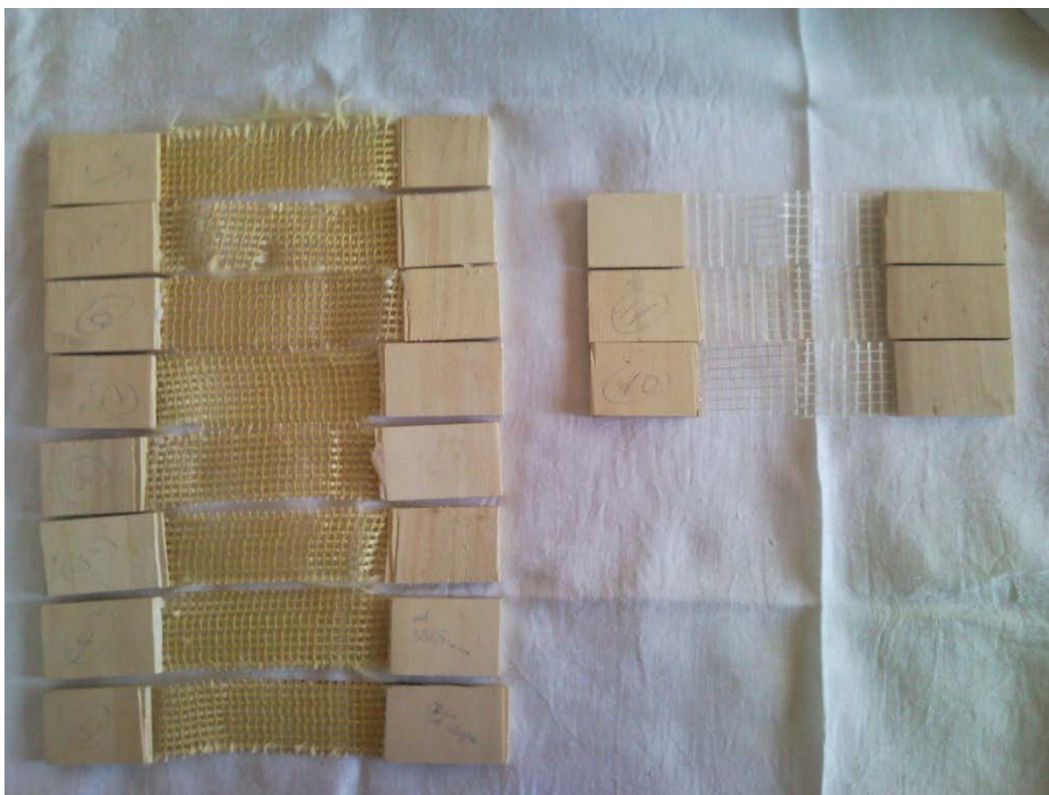
Slika 6: Preskušanci za ugotavljanje natezne trdnosti sintetične mreže
