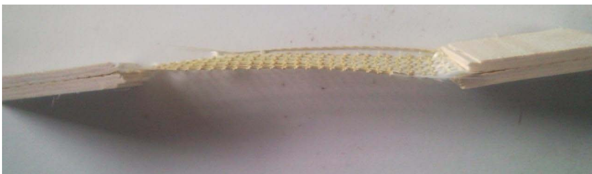
Slika 23: Izgled preskušanca nateznih trdnosti sintetične mreže
