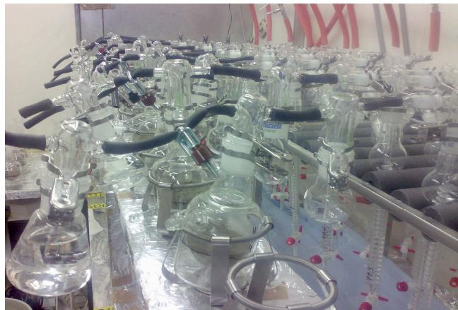
Slika 6: Vlažilec zraka, inkubator s talnim vzorcem, prazna bučka.
