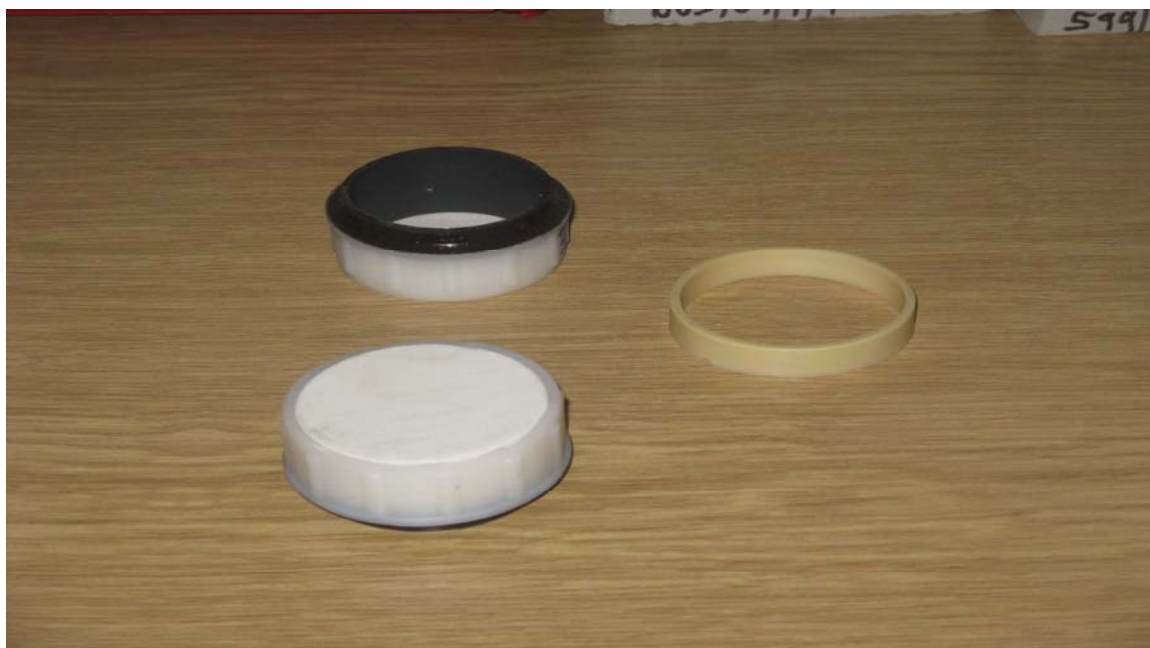
Slika 8: Primer modificiranih obročkov (levo) in standardnih obročkov (desno)
