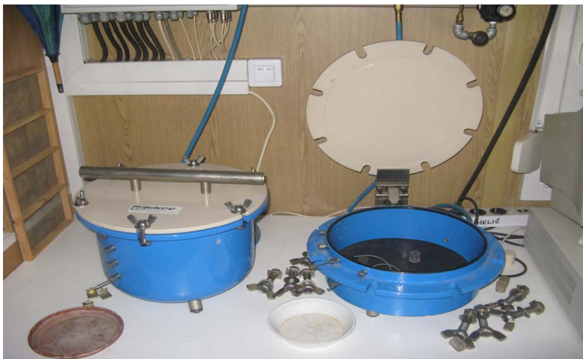
Slika 7: Komora za določevanje vodno zadrževalnih lastnosti tal
