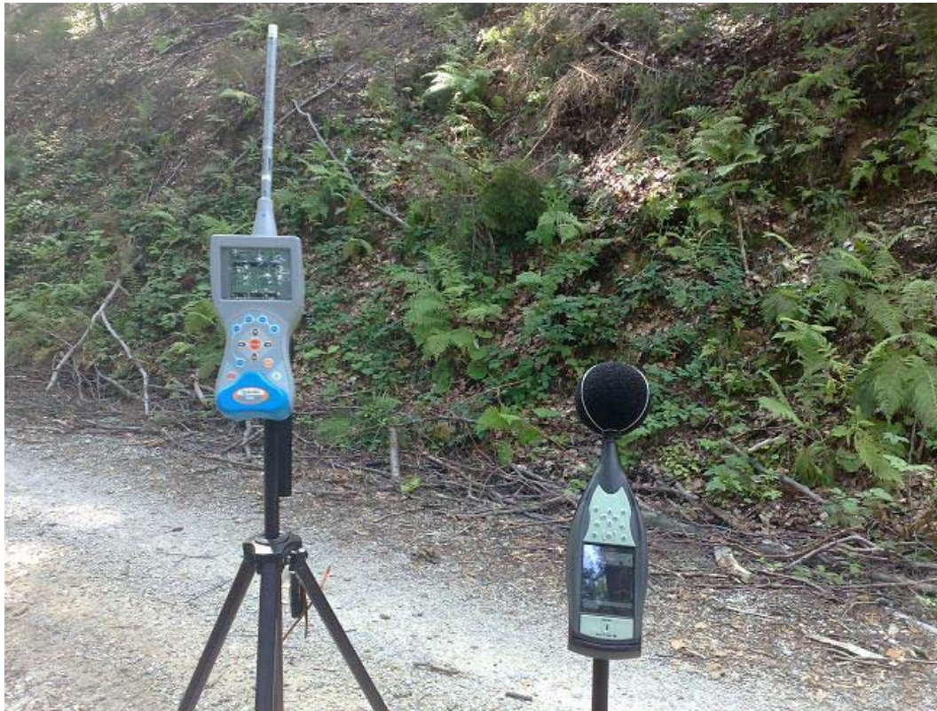
Slika 2: Levo merilnik vremenskih dejavnikov Metrel MI 6401 Poly euro set, desno merilnik hrupa Brüel & Kjaer 2250
