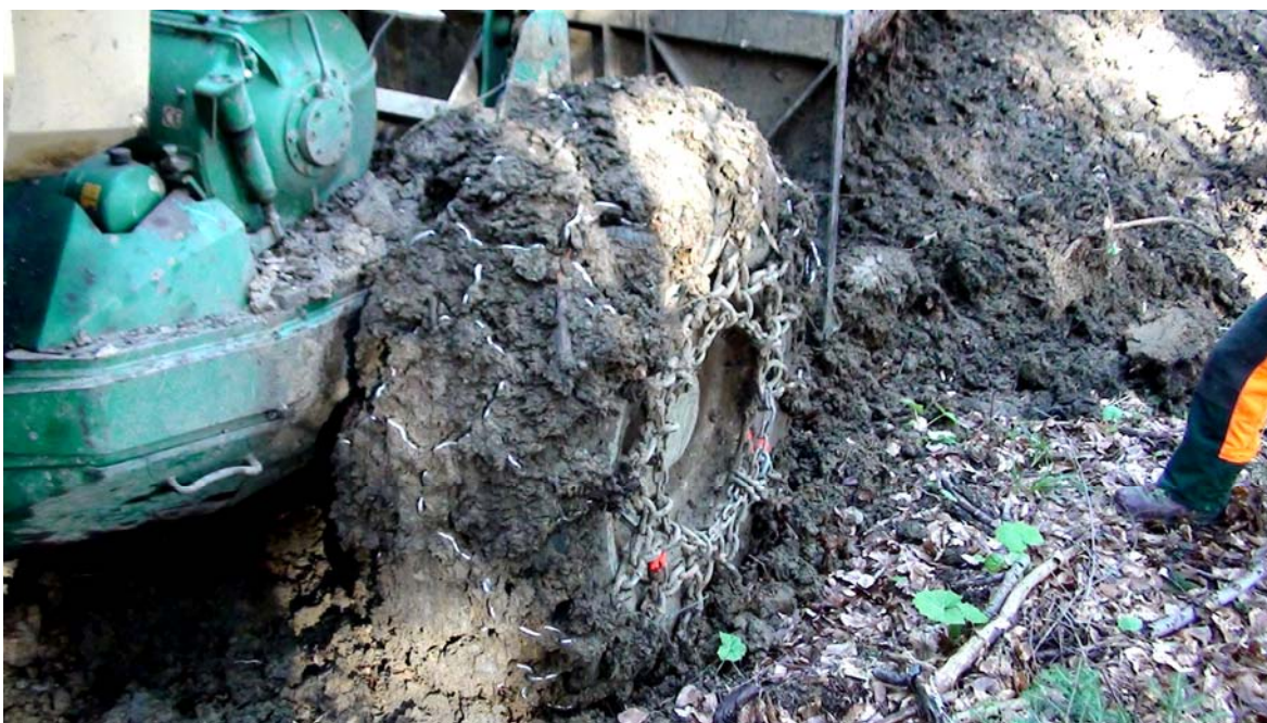
Slika 8: Zablatene verige na traktorju Woody 110 (foto: Matevž Mihelič)
