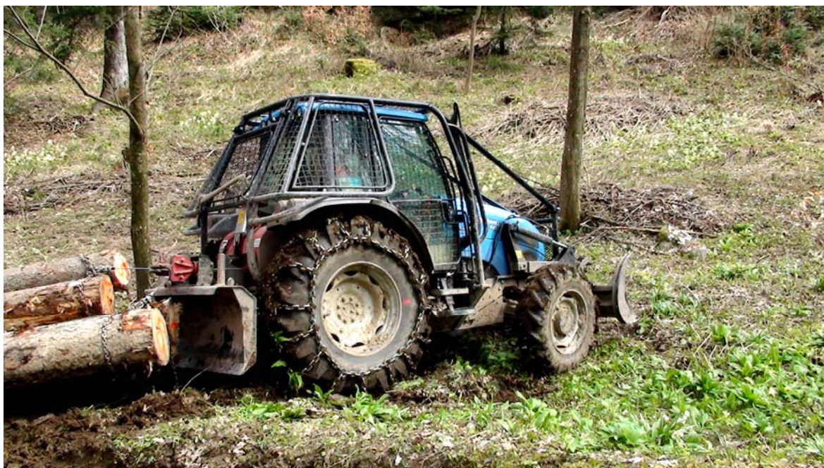
Slika 4: Prilagojeni kmetijski traktor Landini Vision 105 (foto: Matevž Mihelič)
