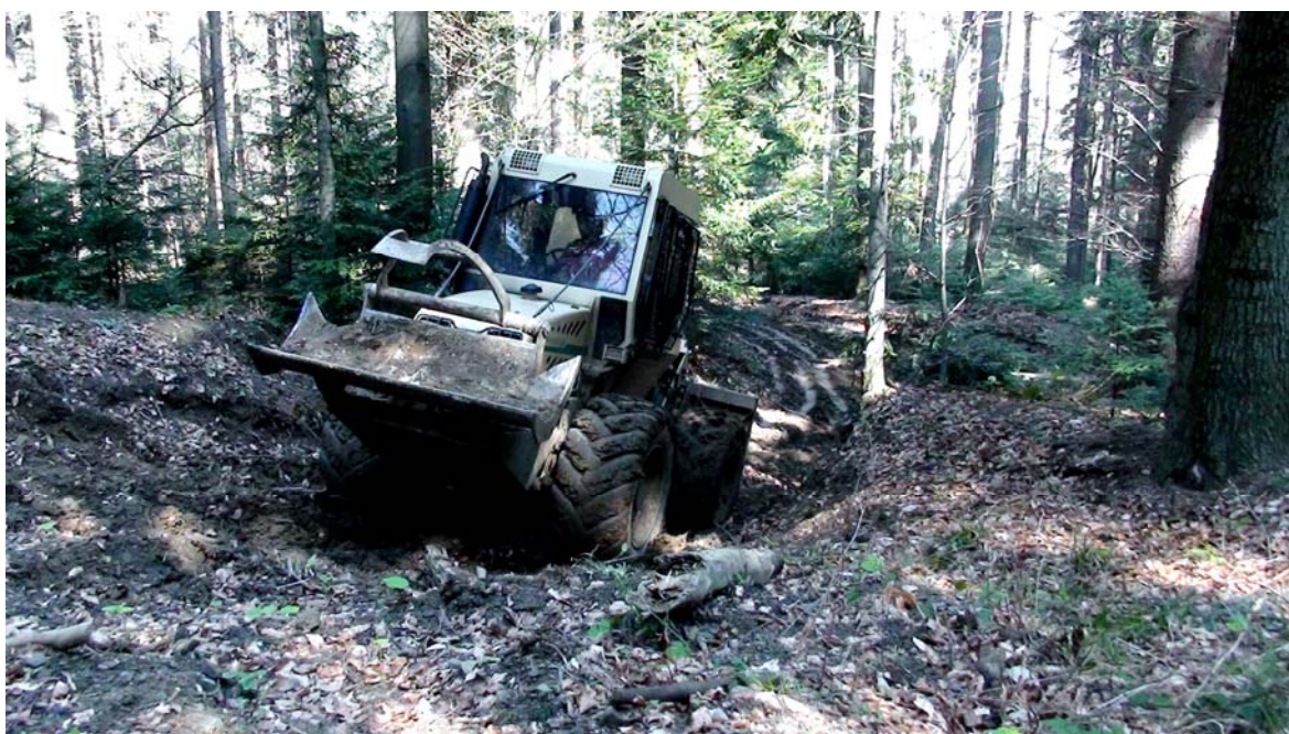
Slika 10: Traktor Woody 110 na mestu zaustavitve, brez verig, tlak 1 bar, naklon 28 % (foto: Matevž Mihelič)
