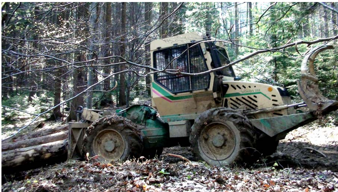
Slika 3: Gozdarski zgibni traktor Woody 110 (foto: Matevž Mihelič)
