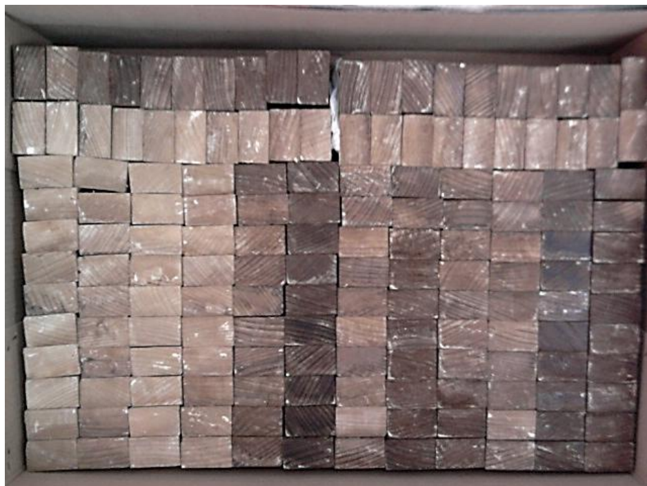
Slika 13: Bukovi modificirani vzorci po izpostavitvi glivi Trametes versicolor
