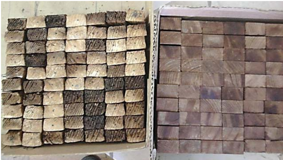
Slika 14: Primerjava kontrolnih borovih in smrekovih modificiranih vzorcev po izpostavit glivi Gloeophyllum trabeum
