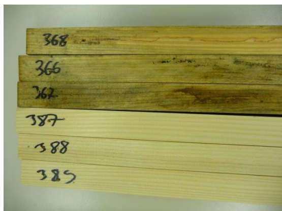
Slika 5: Primerjava spremembe barve kontrolnih in staranih vzorcev smrekovine po 4 mesecih izpostavitve (foto: Nejc Thaler)
