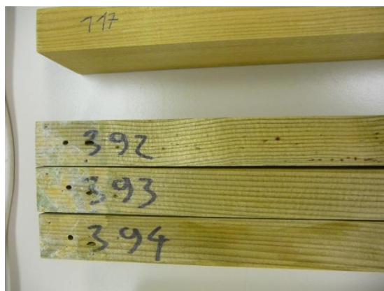
Slika 6: Primerjava spremembe barve kontrolnih in staranih vzorcev zaščitene smrekovine s Silvanolinom® po 4 mesecih izpostavitve (foto: Nejc Thaler)
