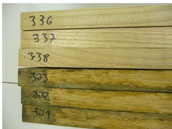
Slika 3: Primerjava spremembe barve kontrolnih in staranih vzorcev kostanjevine po 4 mesecih izpostavitve (foto: Nejc Thaler)
