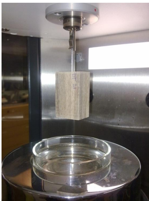
Slika 13: Tenziometer Krüss 100 – meri kapilarni navzem vode v vzorec
