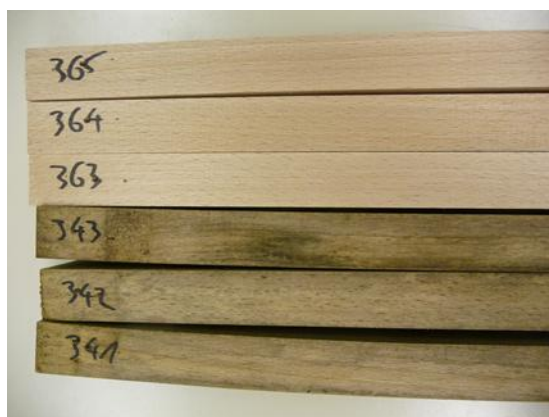
Slika 4: Primerjava spremembe barve kontrolnih in staranih vzorcev bukovine po 4 mesecih izpostavitve (foto: Nejc Thaler)
