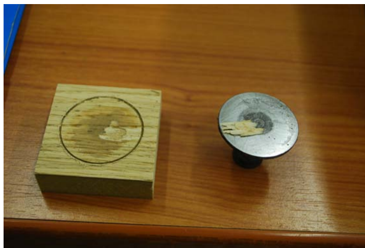
Slika 17: Lom med pečatom, furnirjem in lepilnim spojem
