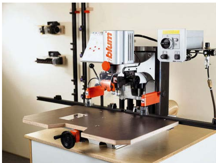
Slika 9: Vrtni stroj BLUM Minipress za vrtnje zareze na preizkušancih
