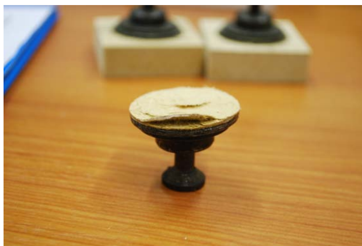
Slika 18: Lom v lepilnim spoju in podlagi
