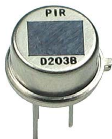
Slika 8: PIR detektor gibanja (foto: Peter Štemberger)
