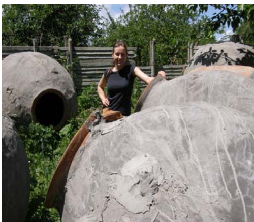
Slika 8: Nekatere dolije na zunanji strani premažejo z betonom
