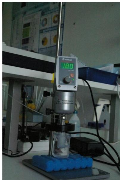
Slika 13: Reaktor za pripravo nanodelcev (foto: Stošicki, 2012)
