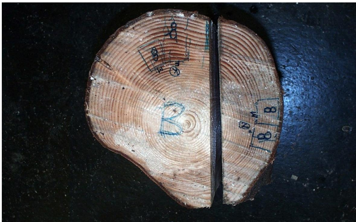
Slika 6: Prečni prerez koluta B z nakazanim vzorčenjem.
