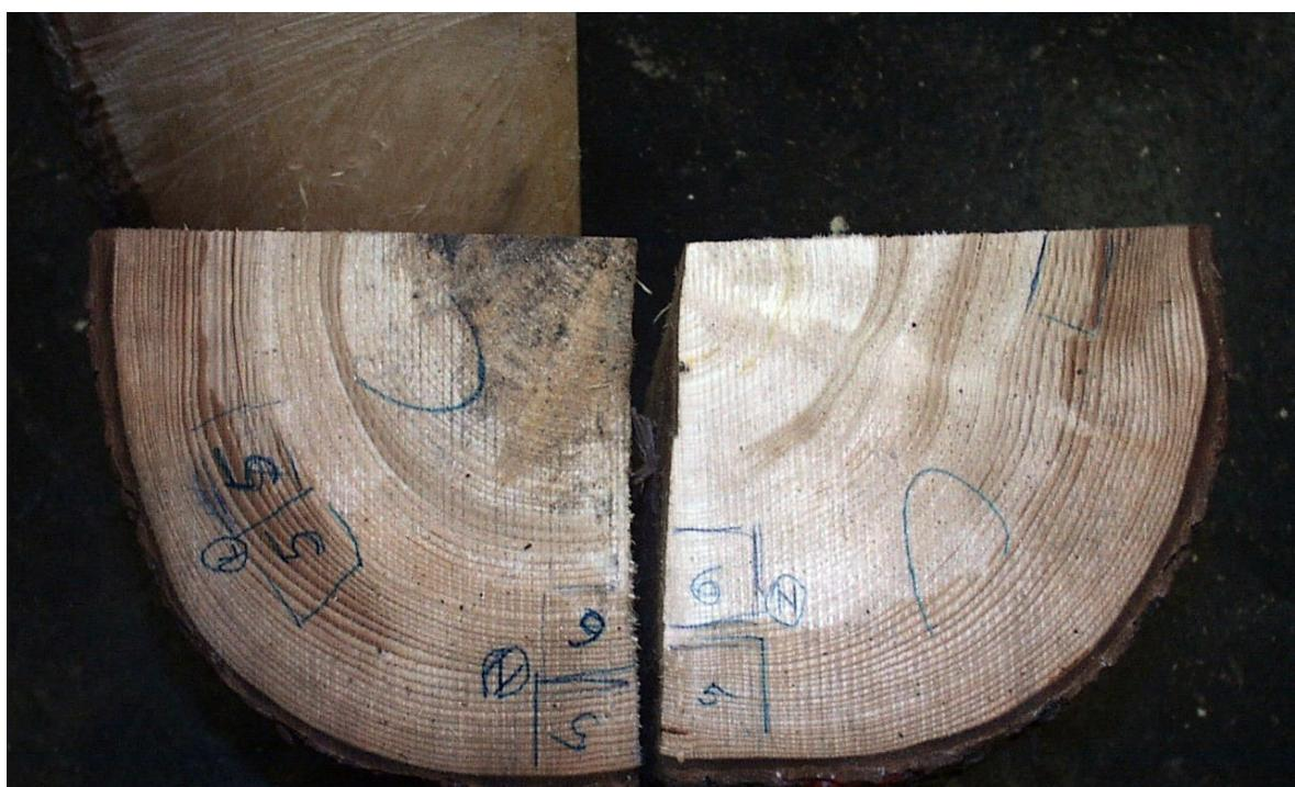
Slika 7: Prečni prerez koluta C z nakazanim vzorčenjem.
