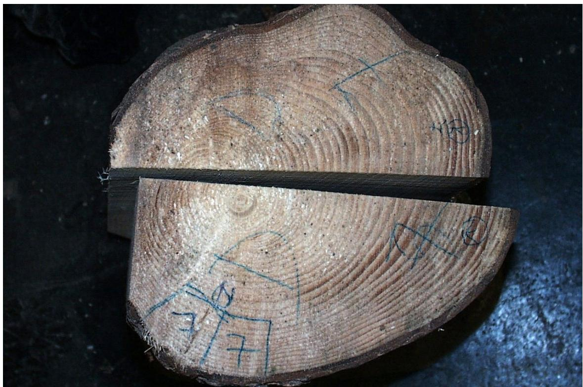
Slika 8: Prečni prerez koluta D z nakazanim vzorčenjem.
