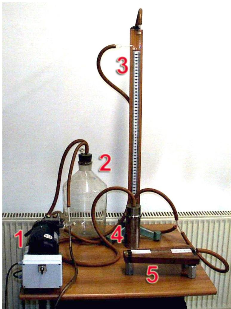
Slika 11: Naprava za merjenje permeabilnosti lesnih vrst z nižjimi pretoki, s pomočjo kalibrirane kapilare. (1. vakuumska črpalka, 2. balastna posoda, 3. živosrebrni manometer, 4. merilna celica, 5. kalibrirna kapilara).
