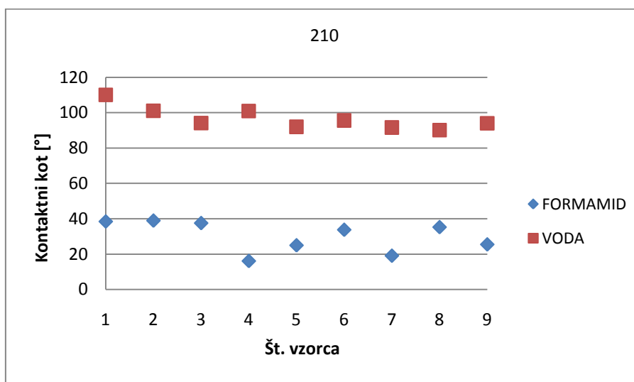
Slika 23. Kontaktni koti pri temperaturi modifikacije 210 °C.
