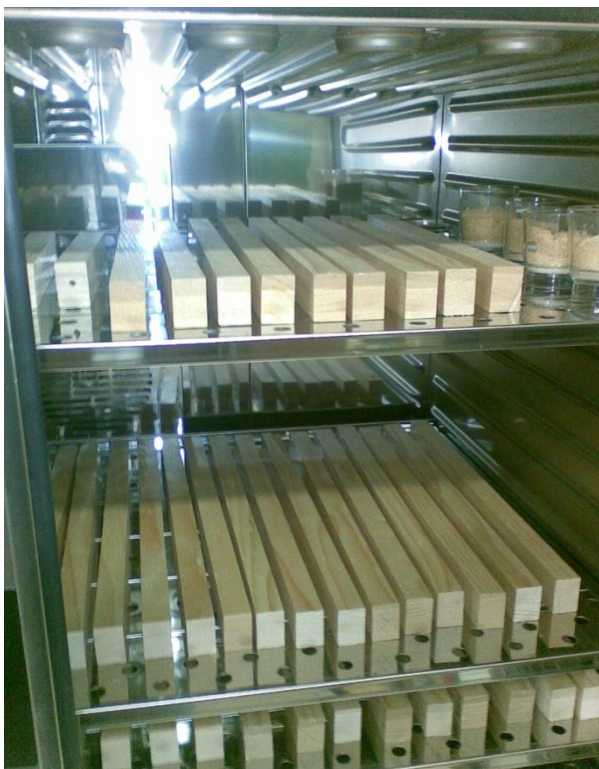
Slika 12. Sušenje vzorcev pred termično obdelavo.
