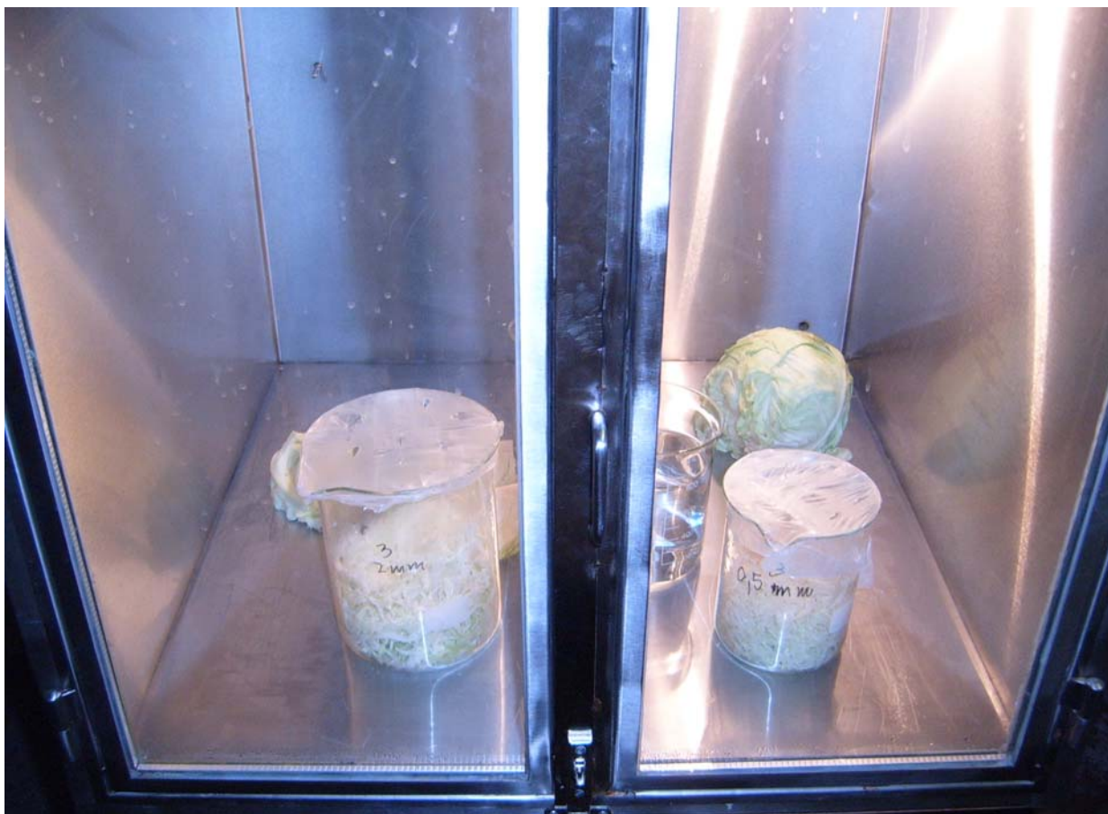
Slika 7: Hladilna komora (8 °C) z vzorci zelja narezanimi na ustrezni debelini (0,5 mm in 2 mm)
