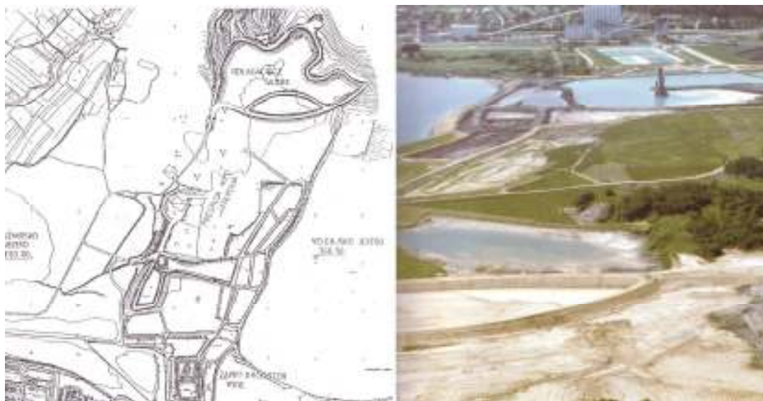
Slika 25: Tlorisni in slikovni prikaz nizanja usedalnikov na pregradi in odlagališča sadre (Šterbenk, 1999)
