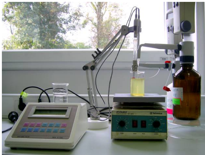
Slika 4: Aparatura za merjenje vsebnosti skupnih in prostih kislin ter laktonov
