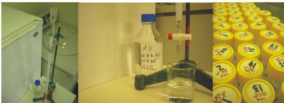
Slika 9: Uporabljena kolona z nosilcem Sepharose CL-4B, pufer za spiranje in zbrane 5 mL frakcije
