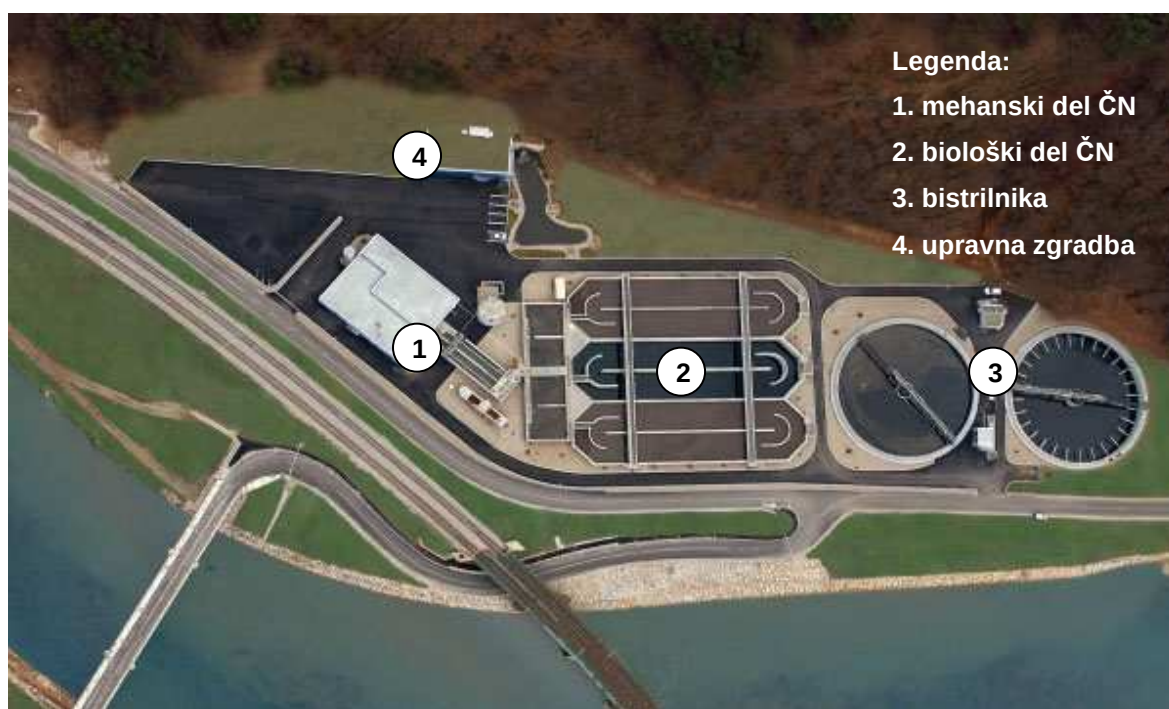
Slika 1 : Tloris Centralne čistilne naprave Celje
