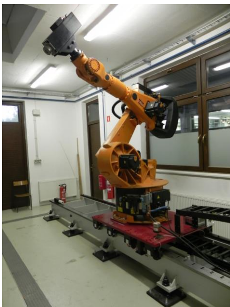
Slika 36: Robot, uporabljen pri aplikaciji rezkanja.
