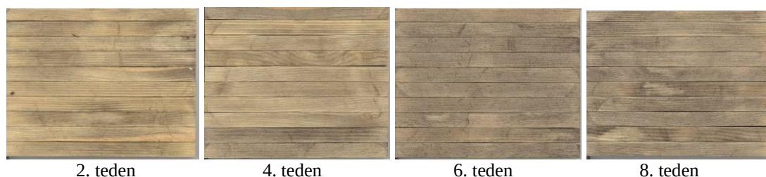
Slika 22: Barvne spremembe na vzorcih okuženih z glivo Sclerophoma pithyophila po 2, 4, 6 in 8 tednu izpostavitve
