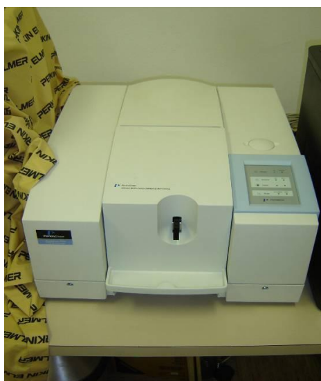
Slika 11: Instrument Spectrum one za merjenje nihajnih (FT-IR) spektrov lesa
