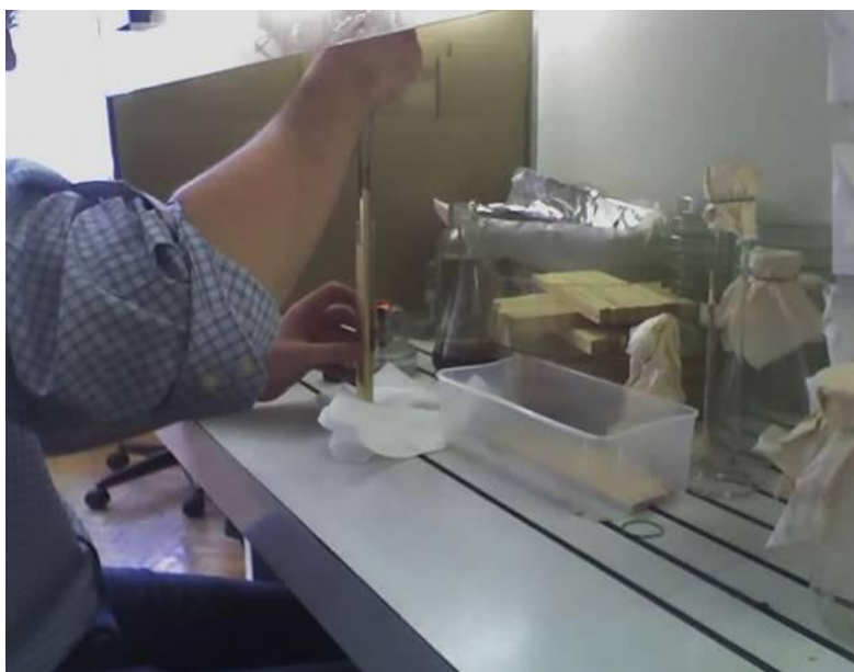
Slika 17: Potapljanje vzorcev v sladni ekstrakt (malt extract) z namenom povečati dovzetnost vzorcev na modrenje
