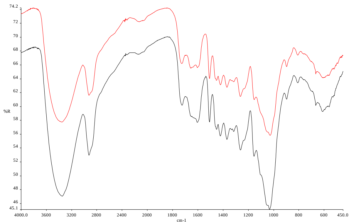
Slika 20: FTIR spekter kontrolnega vzorca (črna krivulja) in vzorca, ki je bil osem tednov izpostavljen glivi Sclerophoma pithyophila (rdeča krivulja)
