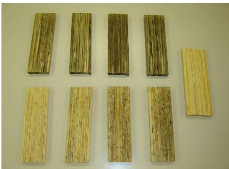
Slika 19: Vizualna razlika med vzorci okuženimi z modrivko Sclerophoma pithyophila (zgoraj) in vzorci okuženimi z modrivko Aureobasidium pullulans (spodaj). Desno pa so kontrolni, glivam neizpostavljeni vzorci
