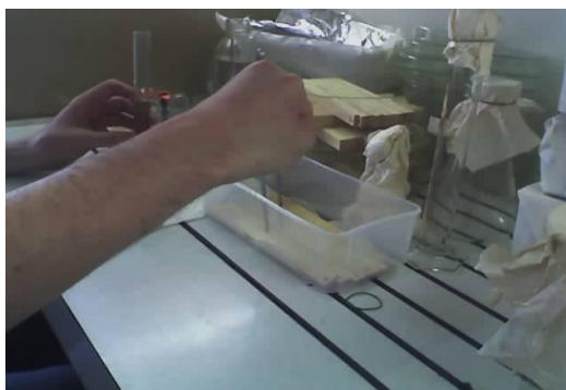
Slika 7: Izpostavljanje vzorcev glivam modrivkam v PP posodah
