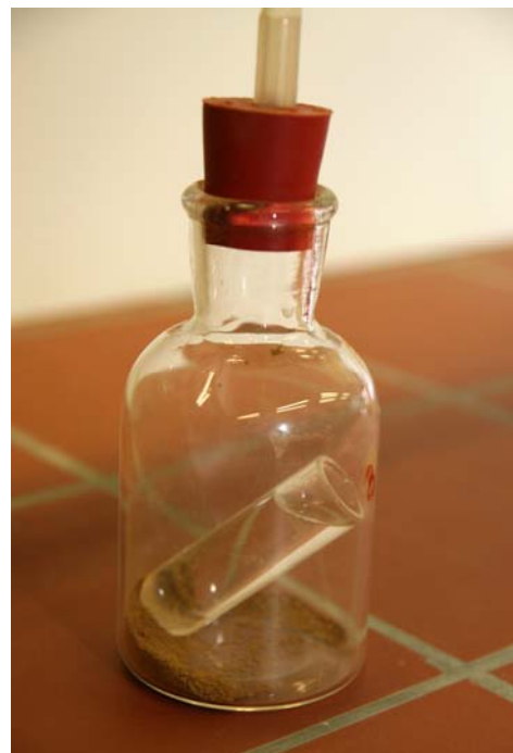
Slika 8: Reakcijski kozarec Scheiblerjevega aparata z vzorcem in HCl.
