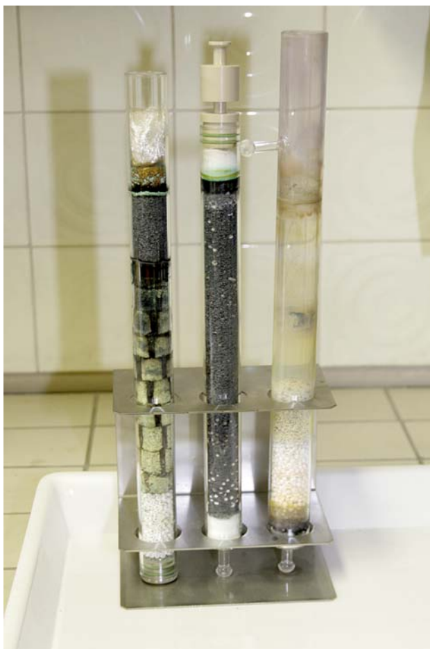
Slika 5: Redukcijska, oksidacijska in post-oksidacijska kolona inštrumenta Vario MAX CN.
