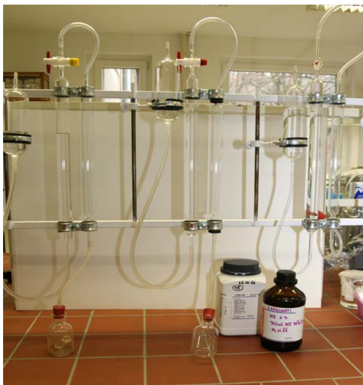
Slika 7: Scheiblerjev aparat za določevanje karbonatov v tleh.
