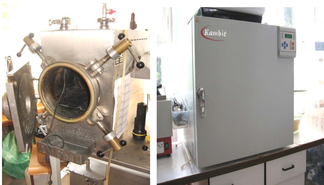
Slika 3: Vakuumsko komora, proizvajalec Kambič (levo) in sušilna komora, proizvajalec Kambič (desno)
