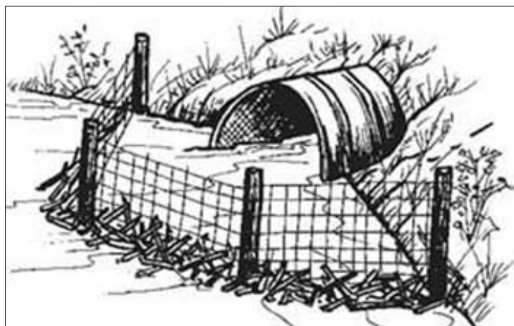
Slika 18: Zaščita cevne prepusta (vir: Beaver damage ... , 2008)
