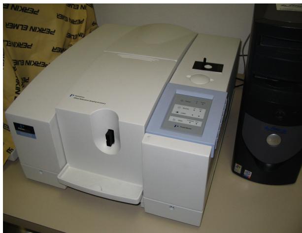
Slika 27: Spektrometer z vstavljenim nosilcem vzorcev.
