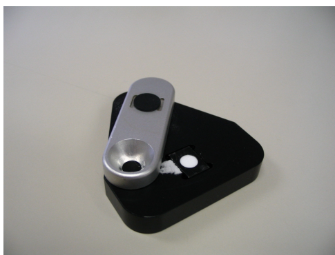
Sliki 25 in 26: Pripomoček za nanašanje vzorca v nastavek in nosilec z vzorcem ter s soljo KBr.
