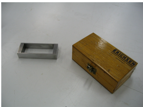
Sliki 9 in 10: Slojnik za nanašanje premazov.
