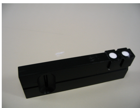
Sliki 25 in 26: Pripomoček za nanašanje vzorca v nastavek in nosilec z vzorcem ter s soljo KBr.
