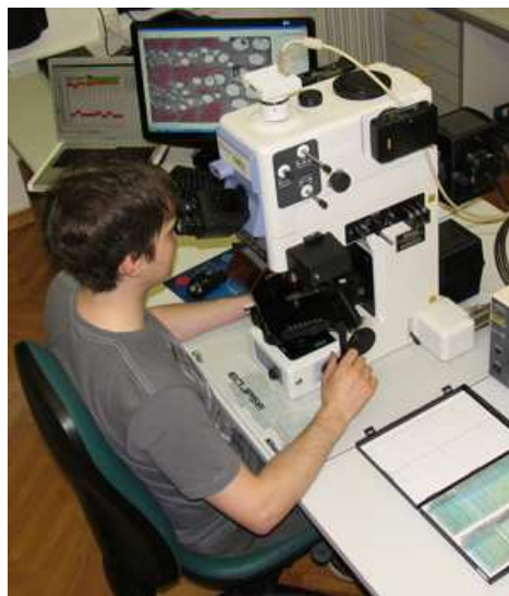
Slika 3: Svetlobni mikroskop Nikon Eclipse 800, digitalna kamera DS-Fi1, v ozadju sistem za analizo slike NIS Elements BR3.
