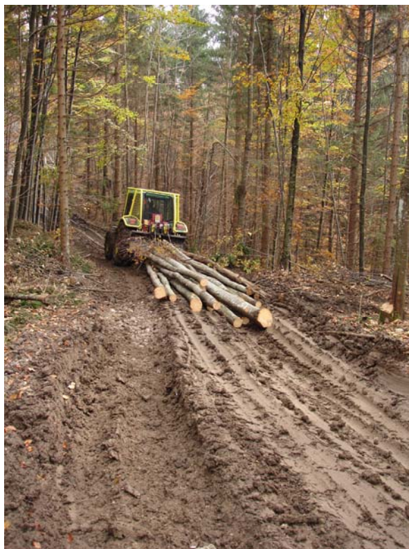
Slika 12: Vlačenje bremena pri spravilu lesa s traktorjem John Deere (foto: U. Vranešič)
