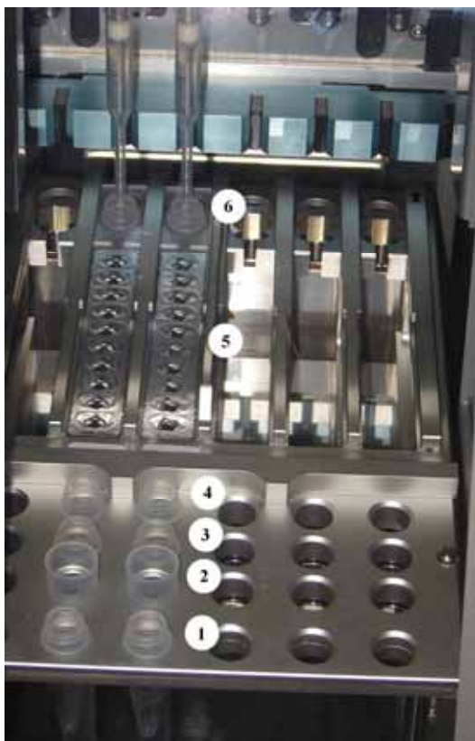
Slika 2: Delovna miza BioRobota EZ1
