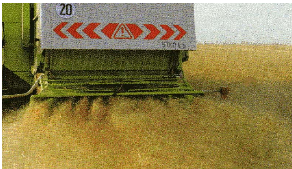
Slika 18: Slamoreznica raztrosi slamo po površini (Medion ..., 2002)
