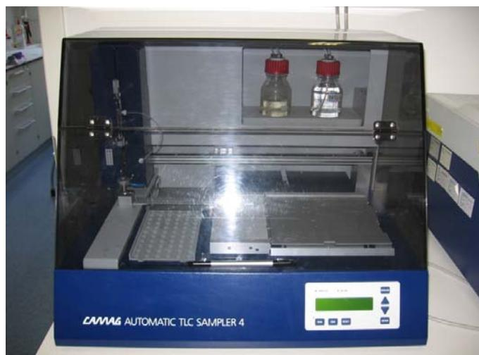
Slika 5: Naprava za avtomatsko nanašanje vzorcev na plošče, Automatic TLC Sampler 4
