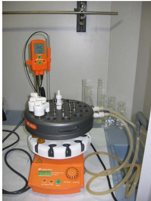
Slika 7: Paralelni sintetizator Carousel 12 reaction station<sup>TM</sup> v katerem istočasno lahko poteka do 12 reakcij in učinkovito mešanje in gretje vzorcev
