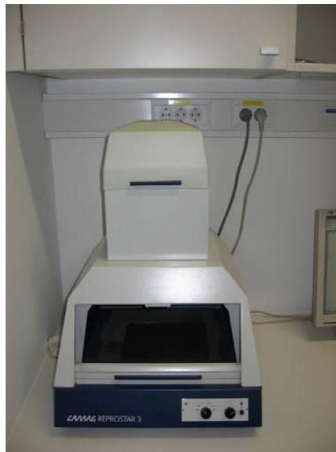
Slika 6: Camag-ov video dokumentacijski sistem DigiStore 2 z Reprostarjem 3 (komora za osvetljevanje) in digitalnim fotoaparatom - sistem za snemanje in arhiviranje slik tankoplastnih kromatogramov
