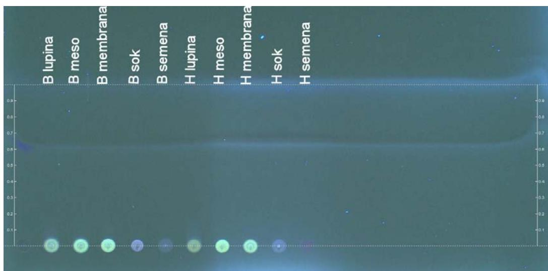
Slika 24: TLC silikagel 60 plošča, razvita v topilu *n*-heksan : etil acetat : mravljična kislina (20 : 19 : 1; v/v), posneta z izvorom svetlobe z valovno dolžino 366 nm
