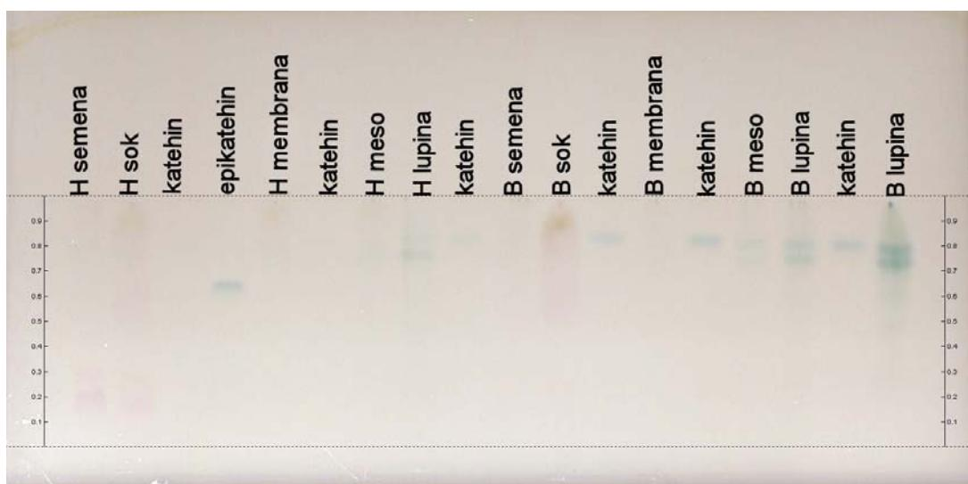
Slika 21: HPTLC celulozna plošča, razvita v topilu  $\text{H}_2\text{O} : 1$  – propanol : ocetna kislina (80 : 20 : 1; v/v/v) po detekciji z reagentom DMACA, posneta z izvorom bele svetlobe. Volumni nanesenih standardov in 10 × razredčenih ekstraktov frakcij so v preglednici 5
