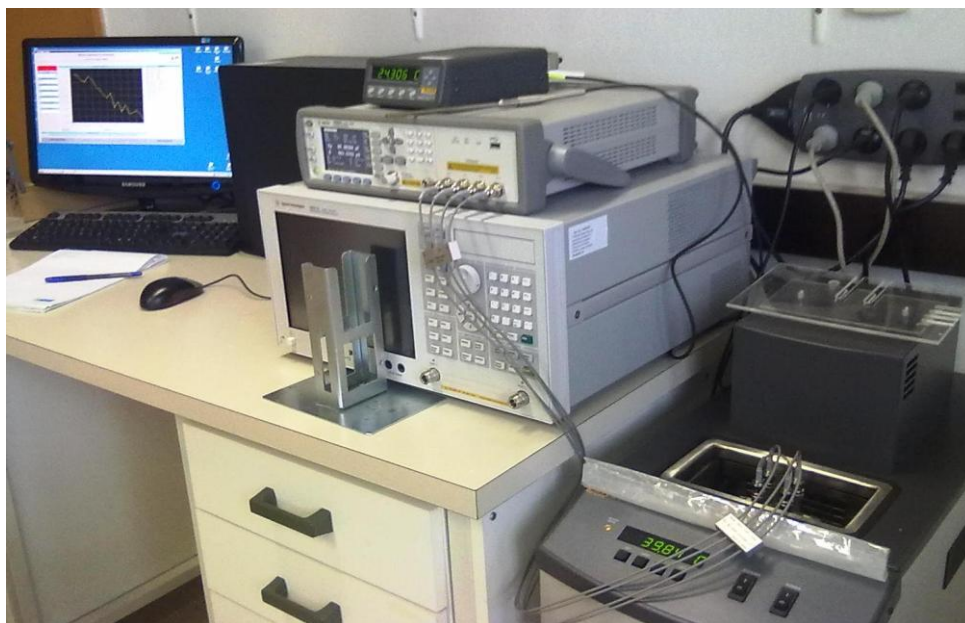
Slika 5: Fotografija računalnika, sistema celice, merilnika za merjenje impedance, termostata in uporabnega termometra.
