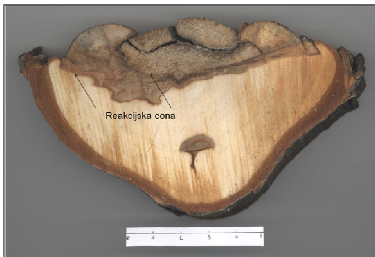
Slika 35: Kolot navadnega divjega kostanja ( Aesculus hippocastanum L.); najmlajša reakcijska cona razmejuje zdravo beljavo in diskoloriran les.
