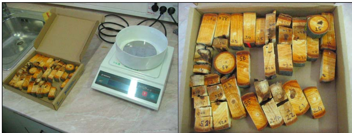
Slika 10: Za pridobitev vlažnosti smo vzorce tehtali z laboratorijsko tehtnico.
