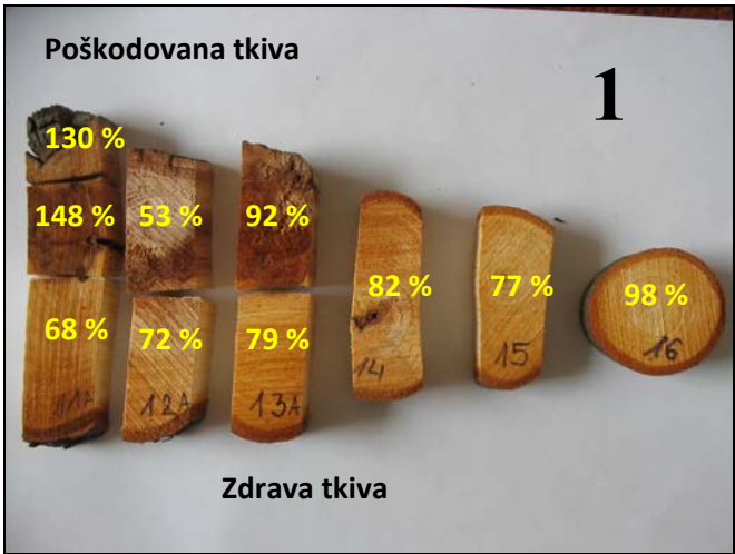
Priloga C: Vlažnost zdravih in poškodovanih tkiv po posameznih drevesih.
