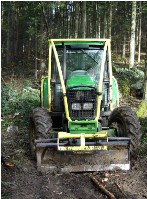
Slika 1: Prilagojen kmetijski traktor John Deere 6220
