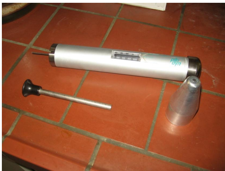
Slika 9: Naprava Pilodyn s pokrovčkom in napenjalno palico (foto: Jernej Klinc).
