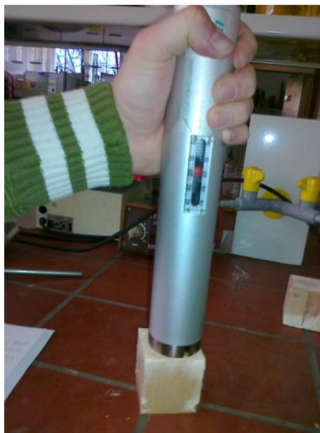
Slika 17: Testiranje vzorcev z napravo Pilodyn (foto: Jernej Klinc).
