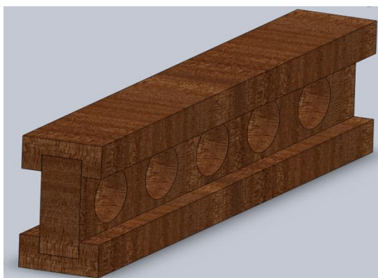
Slika 11: Nosilec, ki se nahaja znotraj X ali H plošče.
