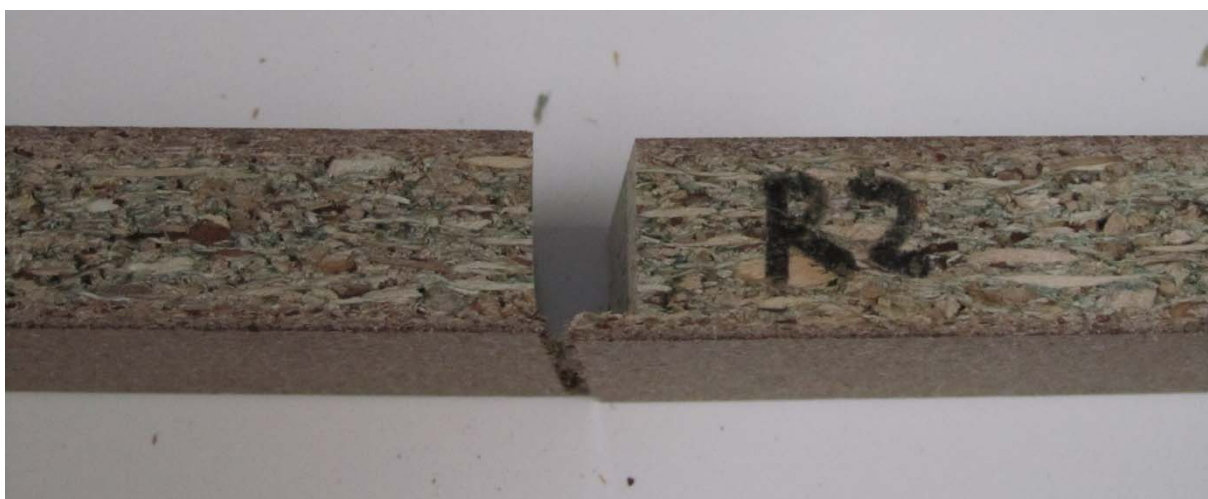
Slika 19: Lom zunanjega sloja iverne plošče
