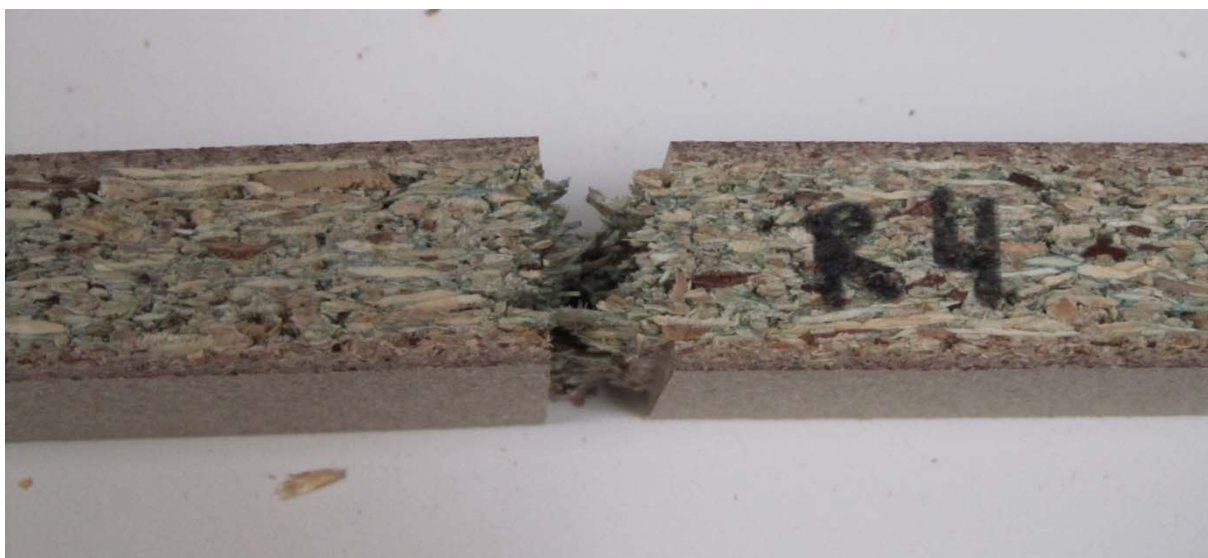
Slika 18: Lom srednjega sloja iverne plošče
