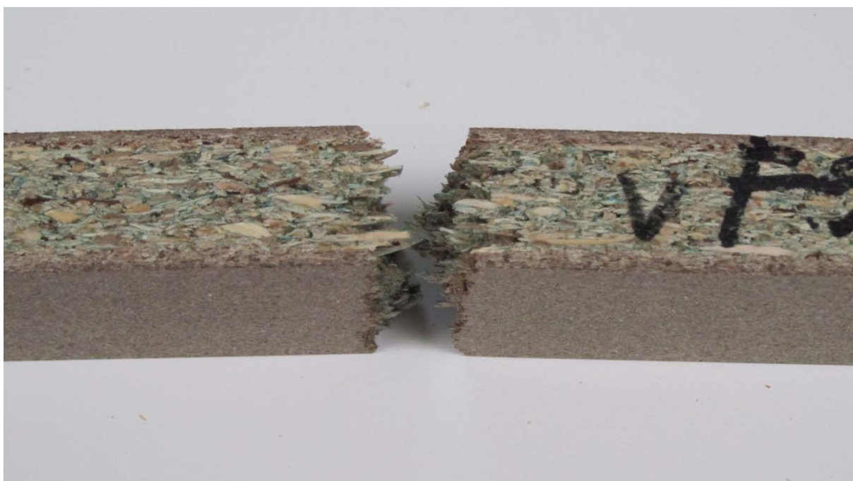
Slika 11: Lom pri vzdolžno orientirani iverni plošči
