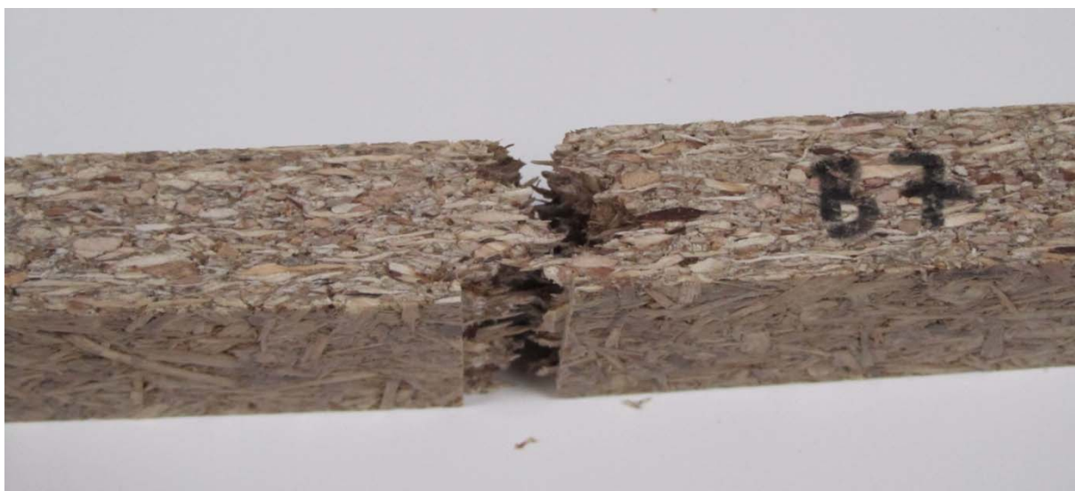
Slika 14: Lom pri srednjem in zunanjem sloju LSB - konstrukcijske plošče
