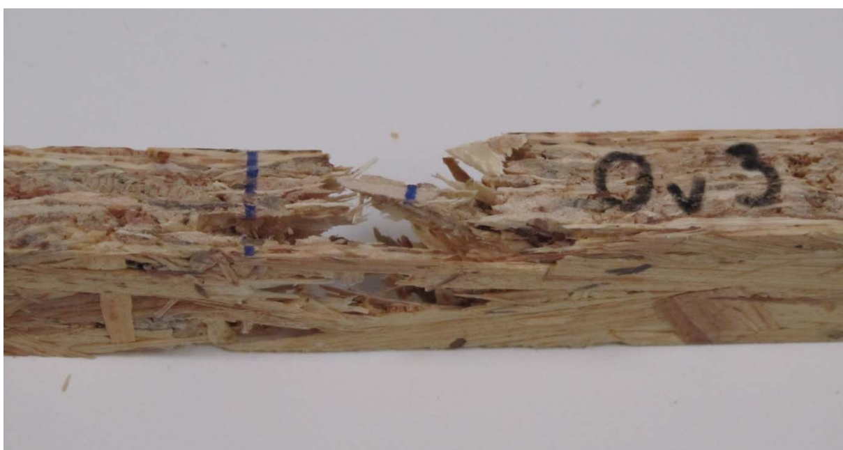
Slika 8: Lom pri vzdolžno orientirani OSB plošči
