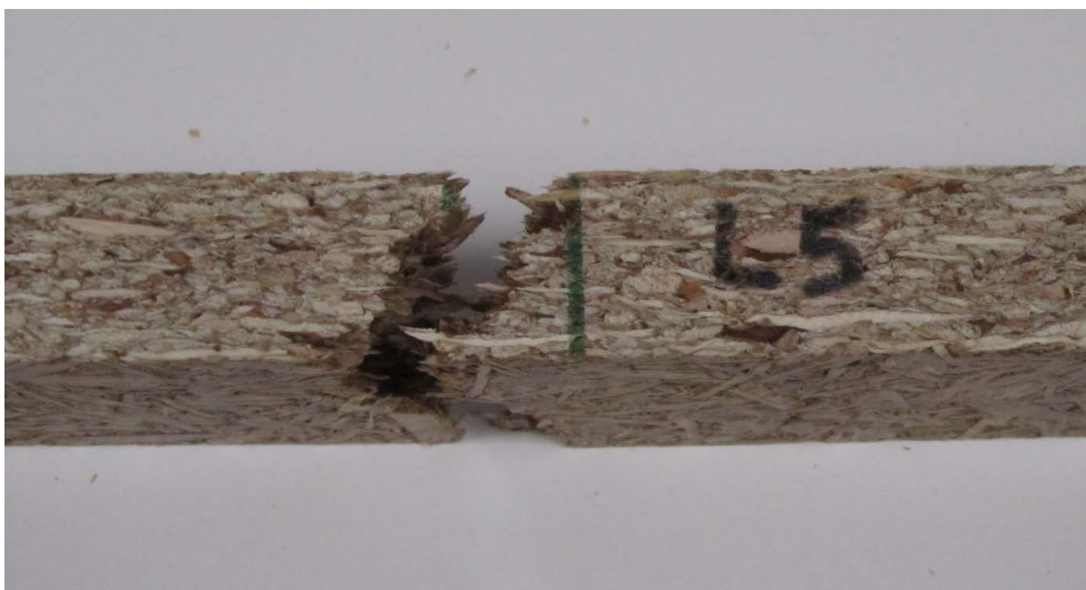
Slika 9: Lom pri LSB - konstrukcijski plošči
