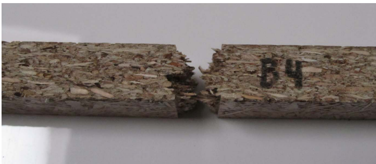
Slika 15: Lom srednjega sloja LSB - konstrukcijske plošče
