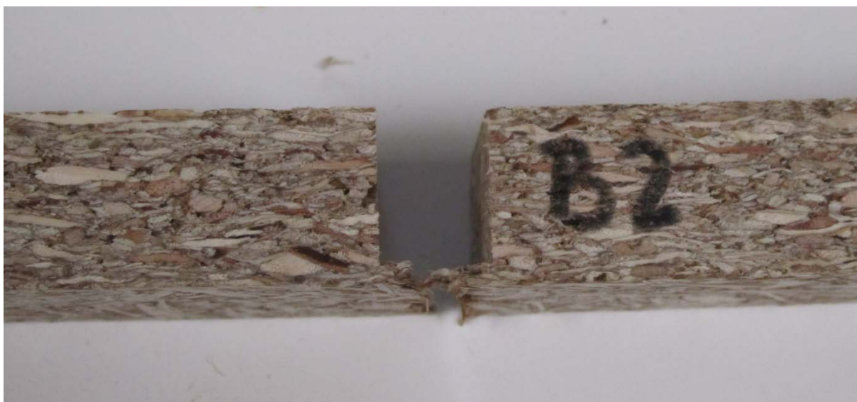
Slika 16: Lom zunanjega sloja LSB - konstrukcijske plošče
