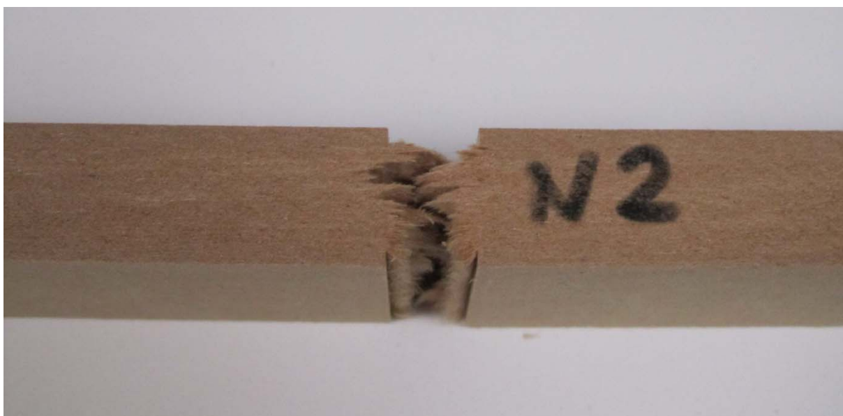
Slika 21: Lom pri srednjem sloju MDF plošče
