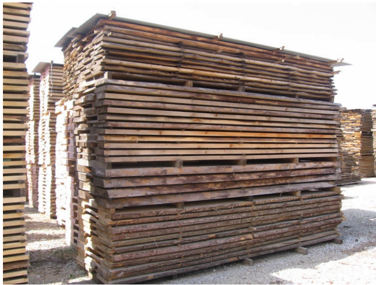
Slika 2: Urejeno skladišče žaganega lesa z učinkovitim sušenjem na prostem (Montpries, 2009).
