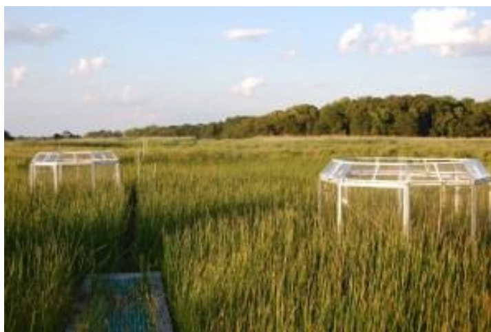
Slika 3: OTC sistem postavljen na polju, premera 2 m in višine približno 1,5 m (Scientists ...,2010).
