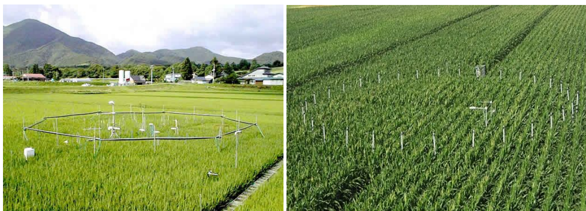
Slika 2: FACE zaplinjevalni sistem; na levi sliki (Carbon Dioxide and Crop Yield in China, 2010) postavljen na polju posejanim s pšenico, na desni sliki (Johann Heinrich von Thunen-Institut, 2008) nekoliko večji sistem na polju koroze.
