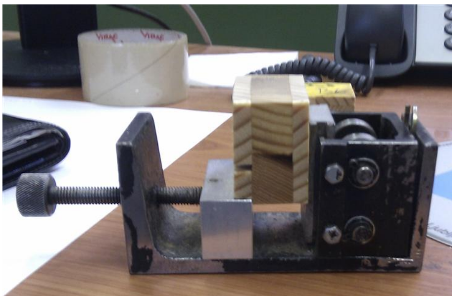
Slika 4: Vpetje preizkušanca v pomožno orodje trgalnega stroja Zwick Z100
