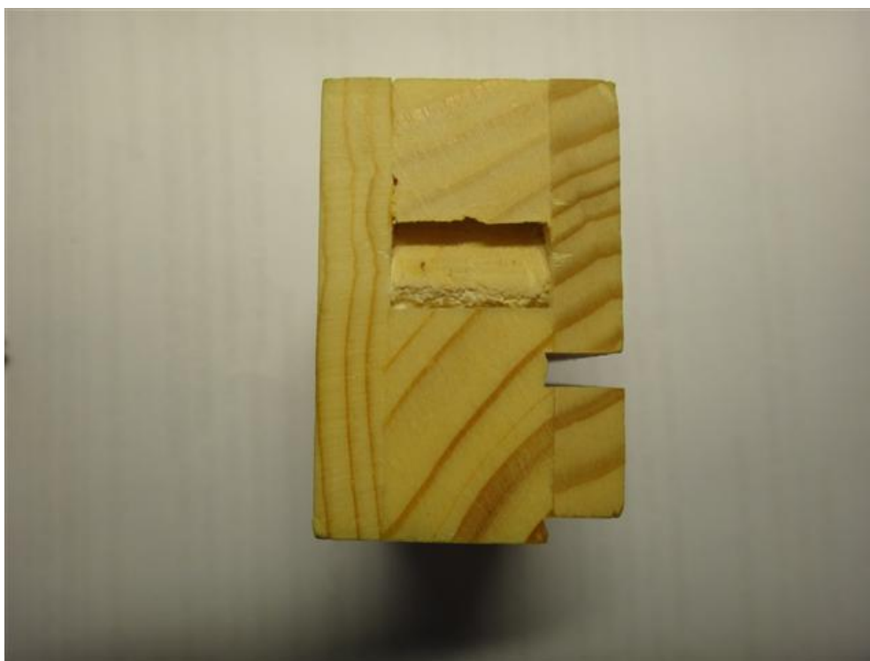
Slika 3: Zažagovanje utorov do lepilnega spoja
