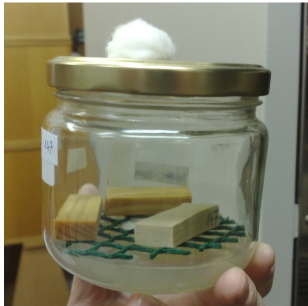
Slika 8: Kozarec s hranilnim gojiščem, mrežico, glivo in vzorci preden smo ga vstavili v rastno komoro
