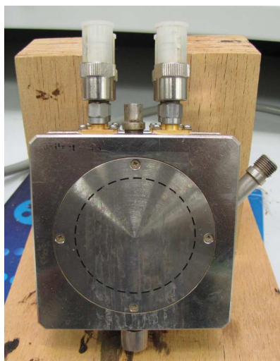
Slika 6: Sonda za merjenje dielektričnih lastnosti tekočin (Agilent 16452 Liquid Test Fixture)
