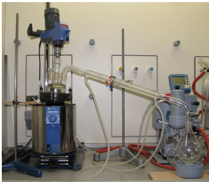
Slika 5: Reaktorska posoda, mehansko mešalo ter hladilnik za odvajanje reakcijske vode
