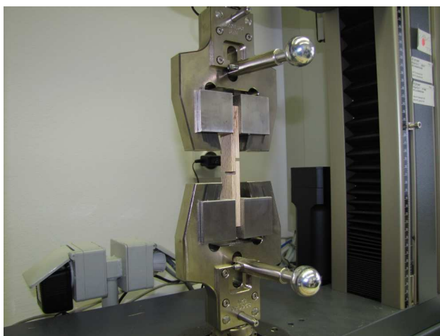
Slika 13: Vpetje preskušanca v čeljusti trgalnega stroja
