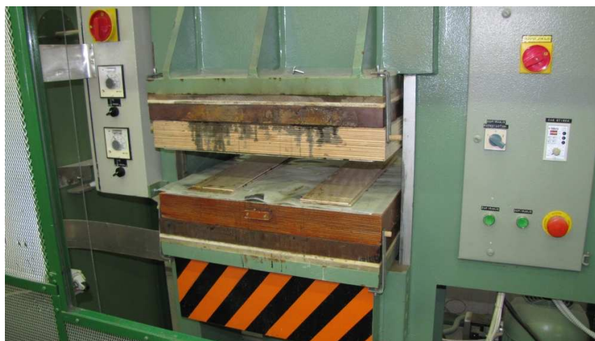
Slika 7: Postavitev lepljencev v visokofrekvenčno stiskalnico
